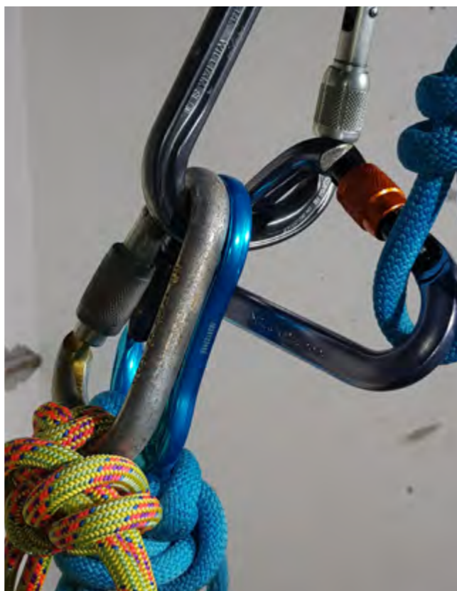
Figure 4: chute en facteur 2 sur un mousqueton sous contrainte (simulation deux personnes vachées 130 kg)
