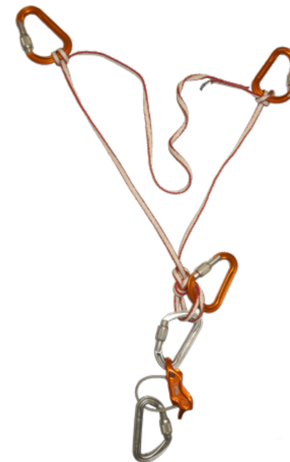
Figure 8: construction du relais avec trois points d'ancrage
