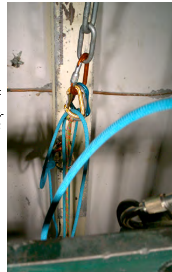
Figure 7: chute d'une masse rigide de 80kg en facteur 1.78 sur un mousqueton Attache 3D (Petzl) précontraint deux personnes vachées 130kg.
